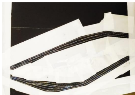
Рисунок 4.11 – Нанесение адгезионной пленки на компрессионное трикотажное полотно
